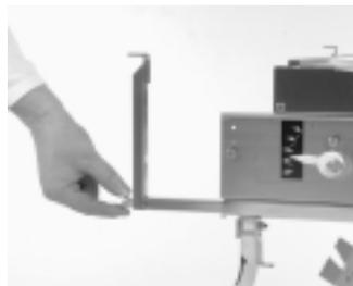
**1.3.** Kleistergerät CB 75 F und CB 1000 F Kunststoffstopfen aus den Rahmenenden entfernen und die beim Geräte-Tisch mitgelieferten Aufnahmewinkel bis zum Anschlag einstecken und Rändelmutter festziehen. Dann Geräte-Tisch von unten einhängen.
