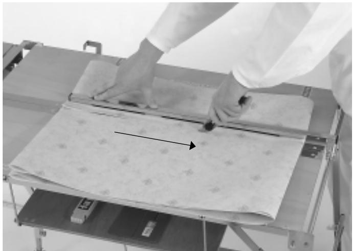
d) Schneiden im „Zugschnitt“
