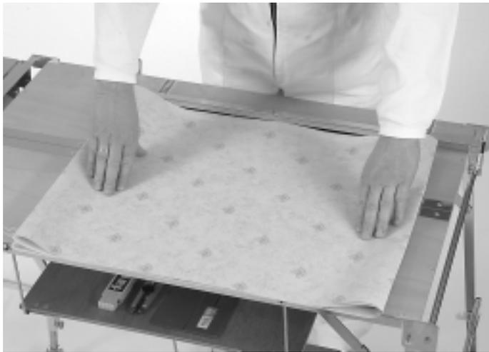
a) Anschlag auf die gewünschte Bahnenbreite einstellen und die mehrmals zusammengelegte Tapetenbahn gegen den Tischanschlag schieben.
