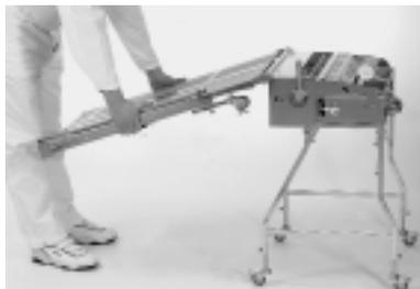
**1.1.** Kleistergerät CB 67 F, CB 800 F und CB 70 mit Untergestell: Geräte-Tisch von unten an den Tischanschlag des Kleistergerätes einhängen.
