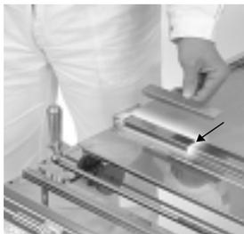
**1.2.** Bei Kleistergeräten CB 67 und CB 800 (nicht fahrbar) muss zuvor das Ausgleichsstück (Pos. 146) angebracht werden.
