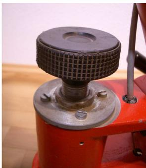
Abb. 3: Schleifdruckregulierung
