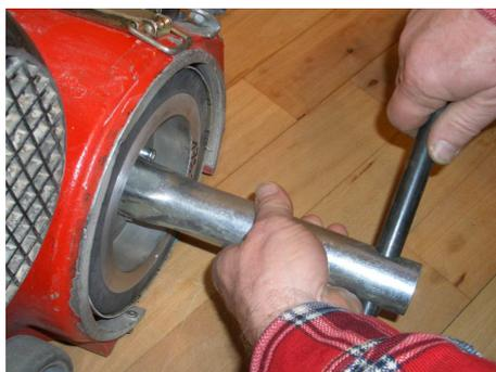
Abb. 6b: Wechsel der Schleifwalze
