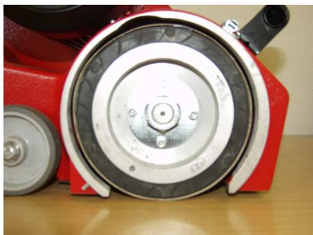
Abb. 5: Wechsel des Schleifbandes
