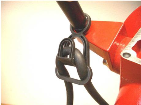
Abb. 1: Kabelzugentlastung
