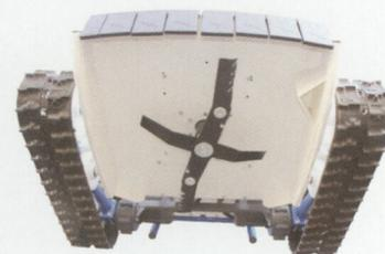
Das **Mähgehäuse** aus 3 mm Stahlblech mit dem innovativem Messersystem garantiert ein hervorragendes Mulchergebnis sowohl vorwärts als auch rückwärts ohne zusätzliche Wendemanöver.
